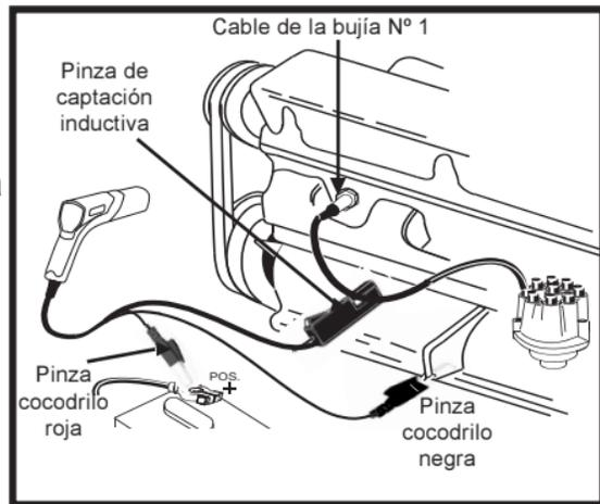
Conecte la pinza de captación inductiva, la pinza cocodrilo roja y la pinza cocodrilo negra
