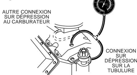
quand la rotation du moteur en tours/minute augmente, comme décrit précédemment, le tuyau à vide peut être fissuré ou ouvert, ou le diaphragme dans le mécanisme d'avance peut être percé.
