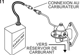
3. Demandez à un assistant de démarrer le moteur. En maintenant le bidon, collectez soigneusement ce que débite la pompe à carburant pendant exactement 30 secondes. L'assistant doit chronométrer précisément et couper le moteur pile aux trente secondes pour que la mesure soit précise. Rebranchez la conduite de carburant au carburateur.
